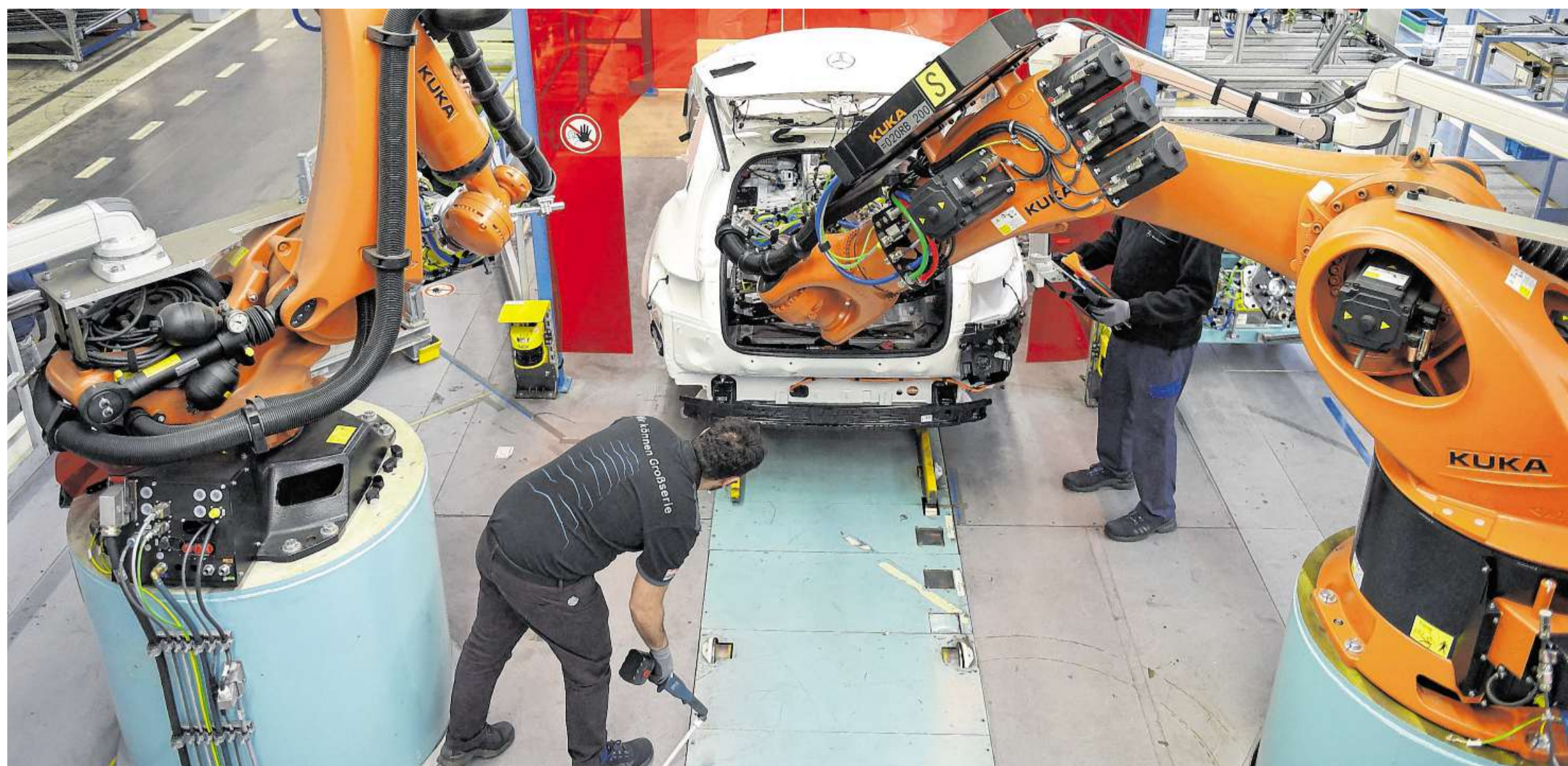
Die Kooperation zwischen Mensch und Maschine schreitet voran: Im Bremer Mercedes-Werk unterstützen Roboter die Mitarbeiter beim Einsetzen einer Batterie – außerhalb des bislang üblichen Käfigs.
