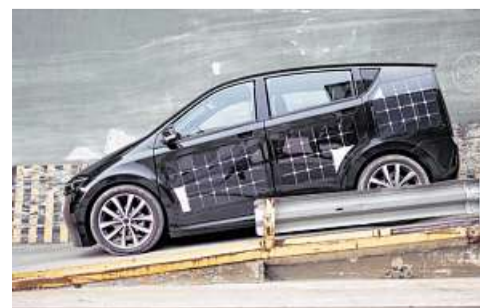
Dank der integrierten Solarzellen soll der Sion bei strahlendem Sonnenschein bis zu 30 Kilometer weit mit dem selbst produzierten Strom fahren können. FOTO: SONO MOTORS
